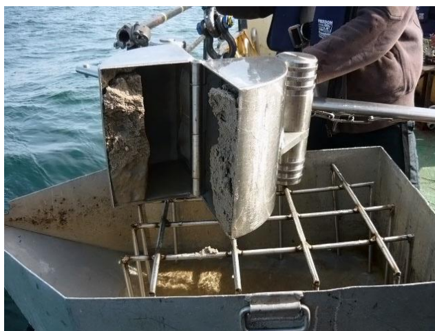
Fotografia 4.2. Pobór próby makrozoobentosu czerpakiem van Veen na dnie miękkim (foto: IMG)
