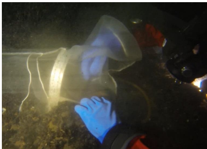
Fotografia 4.3. Pobór próby makrozoobentosu przyrządem DAK na dnie kamienistym (foto: MIR-PIB)
