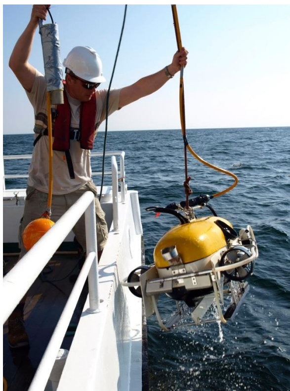
Fotografia 4.1. Zdalnie sterowany pojazd podwodny ROV wykorzystany do inspekcji video fitobentosu (foto: IMG)
